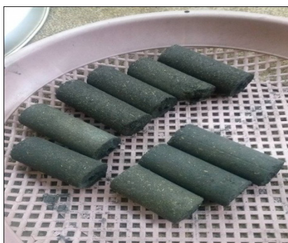
ภาพที่ 1 แท่งเชื้อเพลิงจากถ่านกะลามะพร้าวผสมฟางข้าวและแท่งเชื้อเพลิงจากถ่านกะลามะพร้าวผสมขานอ้อย
