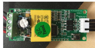
รูปที่ 4 เซนเซอร์วัดพลังงานไฟฟ้า (PZEM004T)
