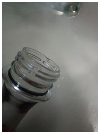
ภาพที่ 4.6 การฉีดหลอดพลาสติก ขนาด A ครีบที่ไม่ได้มาตรฐาน
