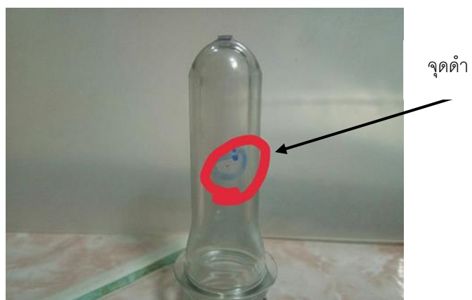
ภาพที่ 4.7 การฉีดหลอดพลาสติก ขนาด B จุดดำที่ไม่ได้มาตรฐาน
