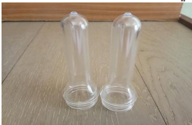
ภาพที่ 4.4 การฉีดหลอดพลาสติก ขนาด B ที่ได้มาตรฐาน
