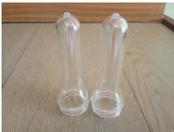
ภาพที่ 4.9 การฉีดหลอดพลาสติก ขนาด A สี่ที่ได้มาตรฐาน
