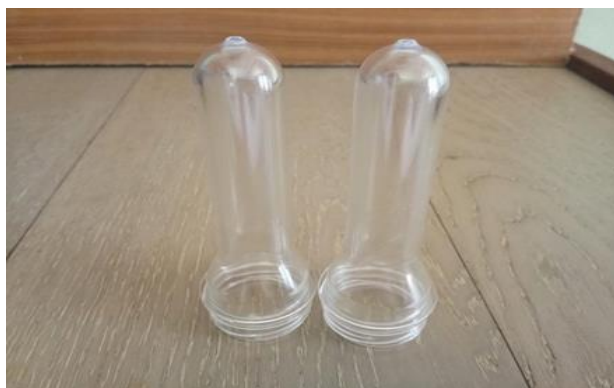
ภาพที่ 4.11 การฉีดหลอดพลาสติก ขนาด A ที่ได้มาตรฐาน
