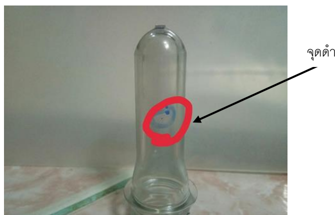
ภาพที่ 4.12 การฉีดหลอดพลาสติก ขนาด A จุดดำที่ไม่ได้มาตรฐาน
