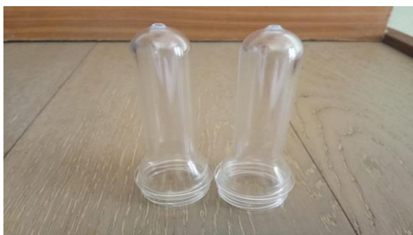
ภาพที่ 4.3 การฉีดหลอดพลาสติก ขนาด A ที่ได้มาตรฐาน
