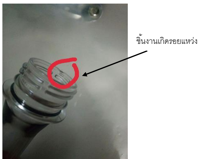
ภาพที่ 4.8 การฉีดหลอดพลาสติก ขนาด C ชิ้นงานเกิดรอยแหวนที่ไม่ได้มาตรฐาน
