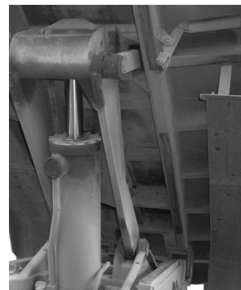
รูปที่ 7 ตำแหน่งที่แรงลัพธ์กระทำกับแท่นยกเทใน
