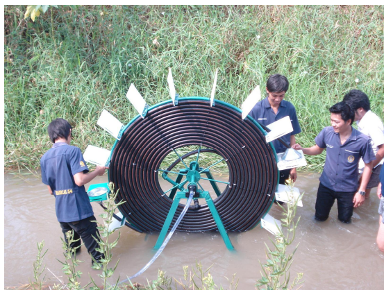
รูปที่ 1 การติดตั้งกังหันน้ำ
