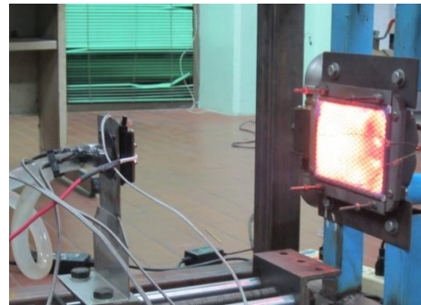
รูปที่ 2 การติดตั้งวัสดุเปล่งรังสี และTPV แบบ 1:1 [8]
