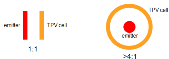
รูปที่ 3 เปรียบเทียบลักษณะของระบบ TPV ที่สนใจพัฒนา
