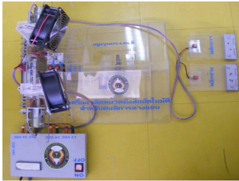
ภาพที่ 4 : ชุดสาธิตการเปิดหนังสืออัตโนมัติสำหรับผู้พิการทางแขน
