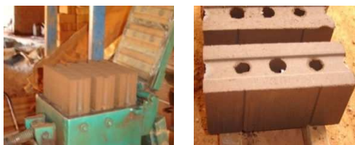
ภาพที่ 4 เครื่องอัดก้อนอิฐมอญซีเมนต์แบบไฮดรอลิก และก้อนอิฐมอญซีเมนต์ผสมเถ้าแกลบ
