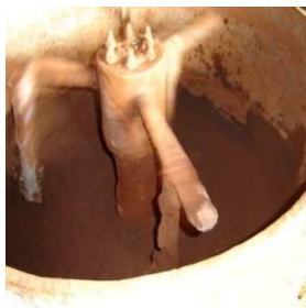
ภาพที่ 3 เครื่องผสมวัสดุ ดินแดง ปูนซีเมนต์ และเถ้าแกลบเข้าด้วยกัน
