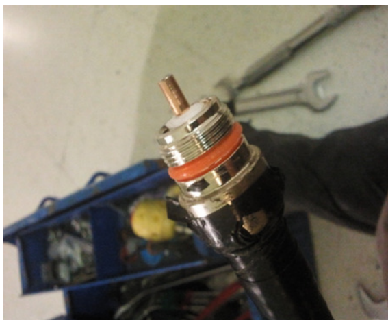
รูปที่ 14 สายส่งที่ต่อกับสายอากาศถ้าสายสัญญาณตัวใน ยาวเกินไปก็ทำให้เกิด PIM ได้
