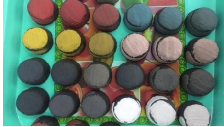
ภาพที่ 7 การทดลองหาเนื้อดินที่ผ่านการผสมสารให้สีแล้ว ที่มา : (อิชฎี รานอก, 2563)
