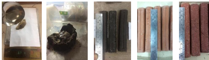
ภาพที่ 4 การทดลองเนื้อดินเหนียวอำเภอบ้านเบิก จังหวัดลพบุรี
