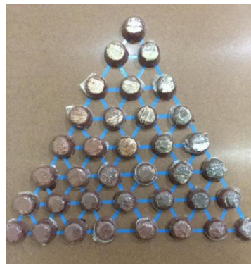
ภาพที่ 5 ผลการทดลองสูตรที่ 1 ที่อุณหภูมิ 1,100 และ 1,200 องศาเซลเซียส บรรยากาศออกซิเดชัน ที่มา : (อิษฏ์ รานอก, 2563)
