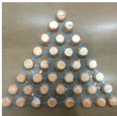
ภาพที่ 5 ผลการทดลองสูตรที่ 1 ที่อุณหภูมิ 1,100 และ 1,200 องศาเซลเซียส บรรยากาศออกซิเดชัน ที่มา : (อิษฏ์ รานอก, 2563)
