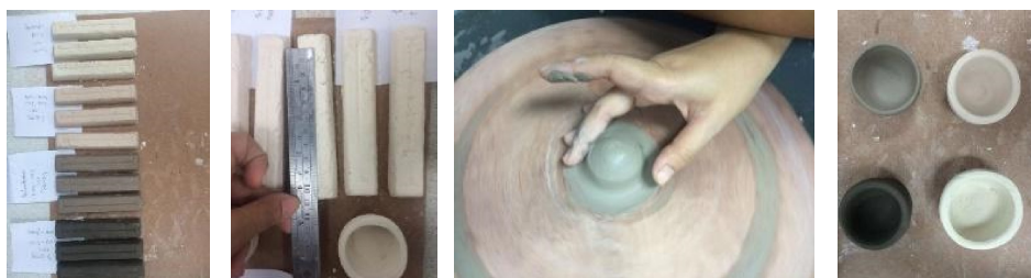
ภาพที่ 3 การทดลองหาค่าการหดก่อนเผาและหลังเผาดิบ
