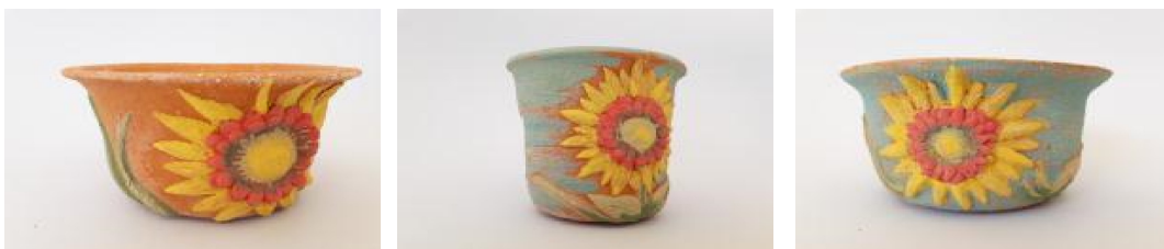
ภาพที่ 12 ผลการทดลองดินสีผสมดินสอพองสูตรที่ 1 จุดที่ 14 บนผลิตภัณฑ์ต้นแบบหลังเผา 1,100 °C ที่มา : (อิชฎี รานอก, 2563)
