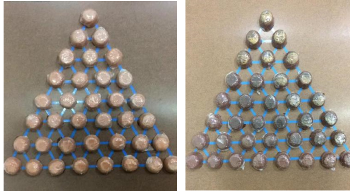
ภาพที่ 6 ผลการทดลองสูตรที่ 2 ที่อุณหภูมิ 1,100 และ 1,200 องศาเซลเซียส บรรยากาศออกซิเดชัน ที่มา : (อิษฎ์ รานอก, 2563)
