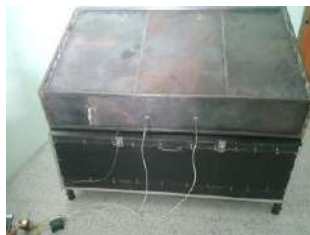
รูปที่ 2 ติดตั้งชุดกำเนิดความร้อนกับตู้อบแห้งเพื่อทำการทดลอง
