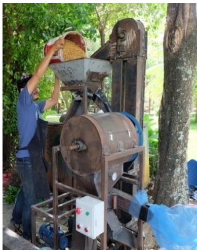
ภาพที่ 9 การทดลองอบลดความชื้นและคัดแยกสิ่งเจือปนในเมล็ดข้าวพื้นเมืองพันธุ์ปะกาอำปิล
