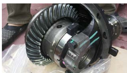
รูปที่ 3 เฟืองท้ายแบบคิฟล็อก [4]
