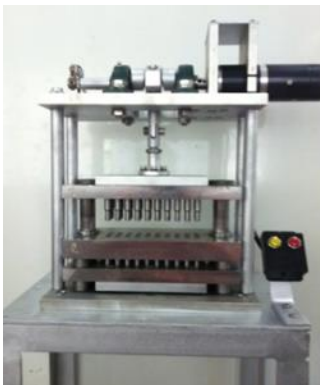
รูปที่ 5 เครื่องอัดเม็ดยาสมุนไพรที่พร้อมเก็บข้อมูล
