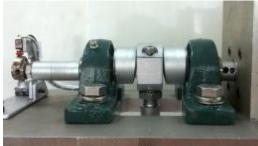
รูปที่ 4 เพลาลูกเบี้ยวทดแม่พิมพ์อัดเม็ดยาสมุนไพร
