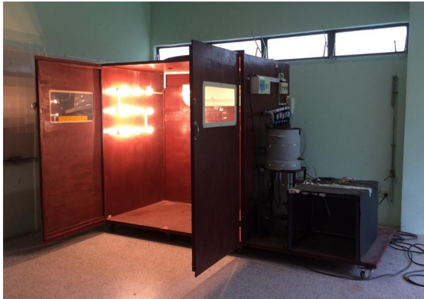
รูปที่ 1 ระบบปรับอากาศที่ติดตั้งถึงกักเก็บพลังงานความร้อน
