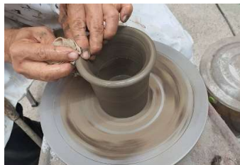
รูปที่ 16 ลักษณะการขึ้นรูปผลิตภัณฑ์ด้วยแป้นหมุน
