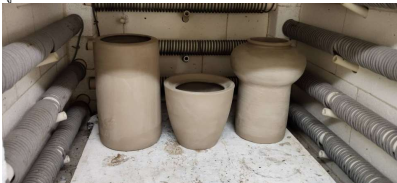
รูปที่ 14 ลักษณะการหล่อน้ำดินลงในแบบพิมพ์เพื่อทดสอบการใช้งาน
