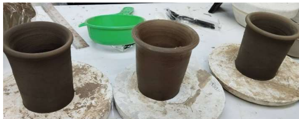
รูปที่ 16 ลักษณะการขึ้นรูปผลิตภัณฑ์ด้วยแป้นหมุน
