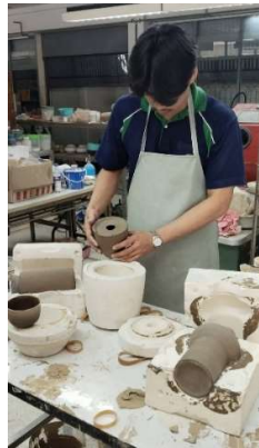
รูปที่ 14 ลักษณะการหล่อน้ำดินลงในแบบพิมพ์เพื่อทดสอบการใช้งาน
