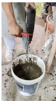
รูปที่ 6 การทดสอบกรองน้ำดินเพื่อหาค่าอัตรากากค้างตะแกรง
