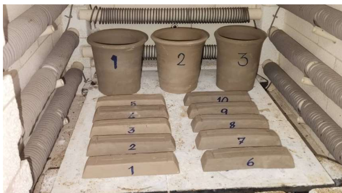
รูปที่ 10 การนำเข้าเรียงในเตาเผาก่อนการเผาครั้งที่ 1 ด้วยอุณหภูมิ 1000°C
