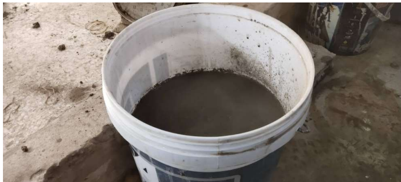
รูปที่ 5 การนำดินทุบละเอียดหมักแช่ในน้ำอัตราส่วนดิน10กิโลกรัมต่อน้ำ 750 โดยน้ำหนัก
