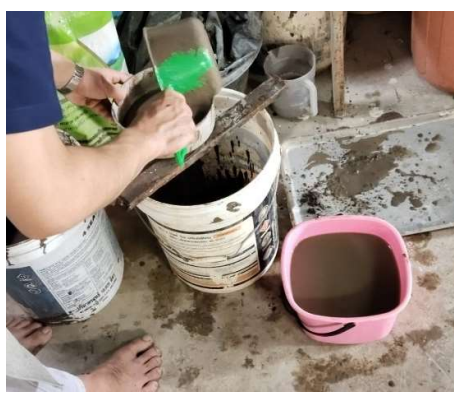
รูปที่ 6 การทดสอบกรองน้ำดินเพื่อหาค่าอัตรากากค้างตะแกรง
