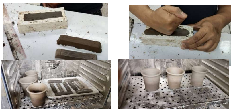
รูปที่ 9 การทดสอบกดอัดแท่งทดสอบขณะมีความเหนียว
