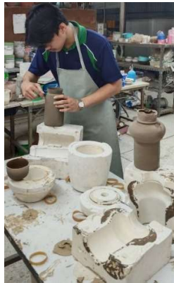
รูปที่ 14 ลักษณะการหล่อน้ำดินลงในแบบพิมพ์เพื่อทดสอบการใช้งาน
