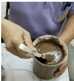
รูปที่ 2 การทดสอบอัตราส่วนระหว่างน้ำหนักดินและปริมาณน้ำ
