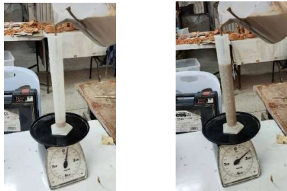
รูปที่ 3 การทดสอบความถ่วงจำเพาะของน้ำดิน
