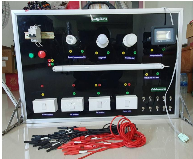
รูปที่ 3.4 ชุดฝึกทักษะปฏิบัติการวิศวกรรมส่องสว่าง ในหัวข้อการหาจุดบกพร่องในวงจรหลอดแอลอีดี (LED) สำหรับนักศึกษาสาขาเทคโนโลยีไฟฟ้าอุตสาหกรรม ที่เสร็จสมบูรณ์พร้อมทำการทดลอง
